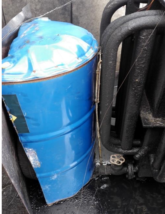
Abbildung 4: Ein halbiertes Ölfass diente bei den Versuchen 4.1 und 4.2 als zusätzliche Abschirmung des brennenden Reifens vor dem direkten Kontakt mit dem flüssigen Löschmittel. Bild: Berliner Feuerwehr, 2017.
