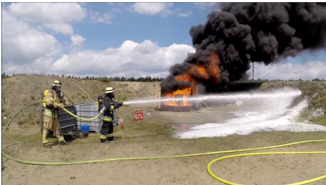
Abbildung 16: CAF nass verfügt über eine deutlich größere Wurfweite als CAF trocken (vgl. Abb. 14). Bild: Berliner Feuerwehr, 2017.
