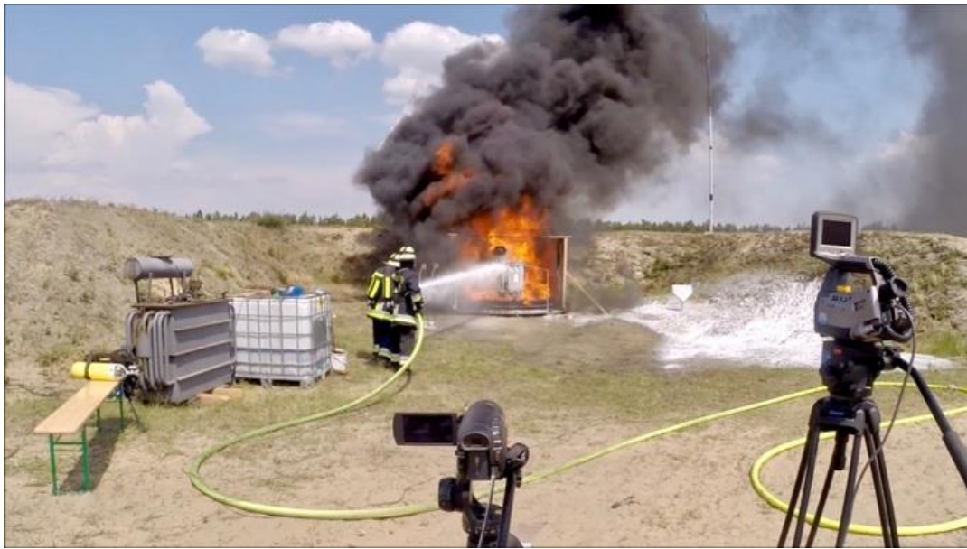
Abbildung 11: Der Löschangriff beginnt. Bei diesem Versuch ist der Sicherheitsabstand deutlich größer. Der Druckluftschaum nass verfügt, im Vergleich zu dem Luftschaumrohr, über eine größere Wurfweite. Bild: Berliner Feuerwehr, 2017.
