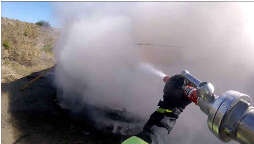
Abbildung 9: Der Löschangriff gegen den Wind verlängerte geringfügig die Brandbekämpfung. Bild: Berliner Feuerwehr, 2017.
