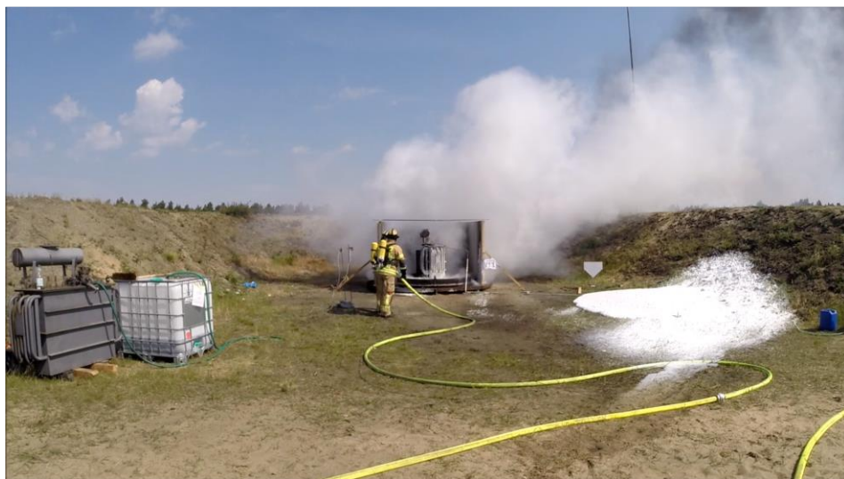
Abbildung 8: 23 Sekunden nach dem Beginn des Löschangriffs ist der Transformatorbrand gelöscht. Bild: Berliner Feuerwehr, 2017.
