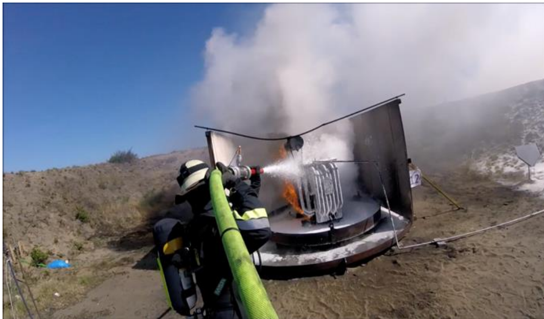
Abbildung 10: Der Reifen führt zur Rückzündung. Lösch- und Kühlmaßnahmen sind erneut erforderlich. Bild: Berliner Feuerwehr, 2017.
