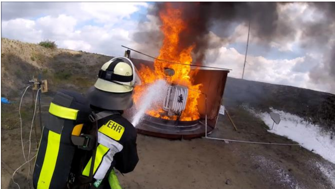
Abbildung 12: Der haftende Schaum zeigt, dass die Trafo-Oberfläche an dieser Stelle bereits erfolgreich gekühlt werden konnte. Bild: Berliner Feuerwehr, 2017.
