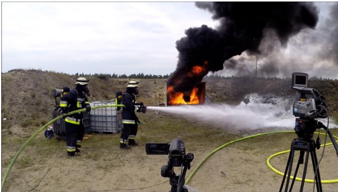
Abbildung 15: Druckluftschaum trocken hat eine geringere Wurfweite als Druckluftschaum nass. Bild: Berliner Feuerwehr, 2017.
