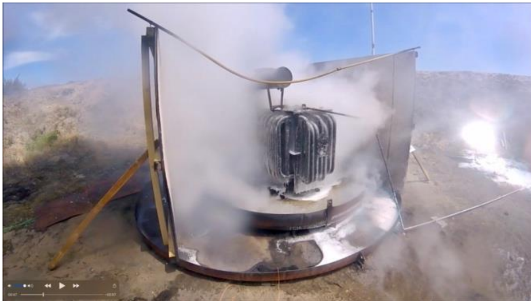
Abbildung 18: Das Netzmittel verfügt im Gegensatz zu Druckluftschäum über keine Haftwirkung an der Außenseite des Transformators. Bild: Berliner Feuerwehr, 2017.
