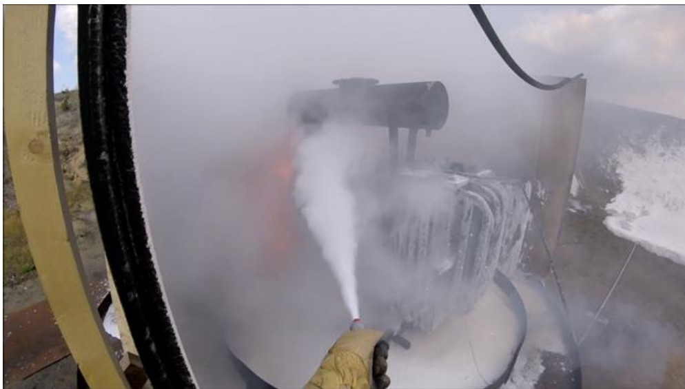
Abbildung 17: Pulverwolke für den abgeschirmten brennenden Kfz-Reifen. Nach den Kühl- und Löschmaßnahmen kommt der PG12 zum Einsatz. Bild: Berliner Feuerwehr, 2017.
